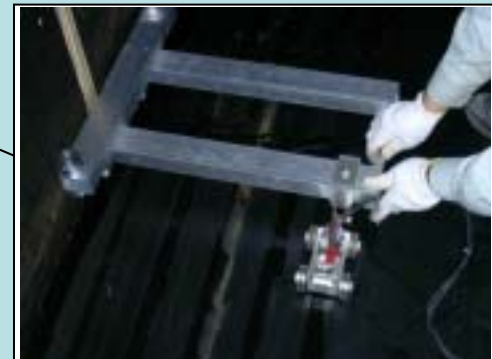
底板測定(円周方向)
