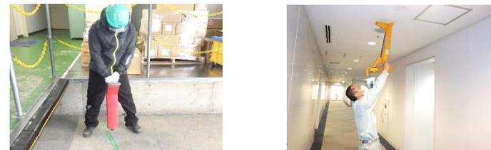
電気配線からの漏洩電波に反応する事が経験的に知られている。受信レベルの強弱で電気配線を判断する。
