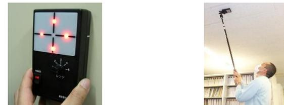
電気配線からの漏洩磁場に反応する装置。磁場なのでモーターに強く反応する。
